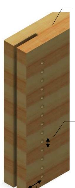
Entalladura con un espesor de 9 mm y una profundidad de 115 mm sobre toda la altura de la viga, en su extremidad
